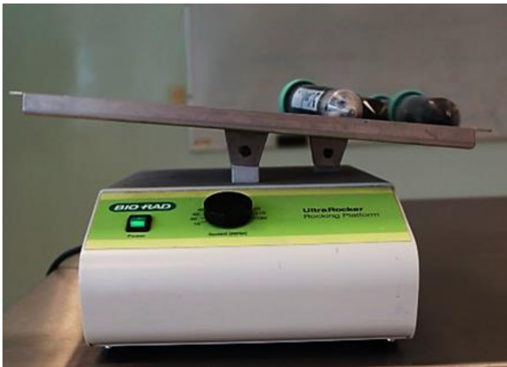
Figura 23 Se sumergen en ella durante 6 horas, se obtura la cámara pulpar con ionómero de vidrio se colocarán los dientes inyectados en un vibradorbordex o cámara de vacío durante dos horas
